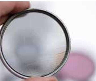
➤ Bei diesem alten, defekten Polfilter kann man die Beschädigung der Polfilterfolie erkennen
